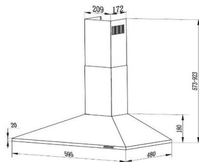
\* = Abluftbetrieb: bei Anschluss an einen Entlüftungskamin bzw. Abluft in's Freie (Mauerdurchführung 150 mm / Bohrung 160 mm)
